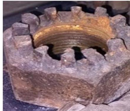
**Tipo de corrosión:** Corrosión galvánica.**Apariencia:** La rosca de la tuerca del material presenta desprendimiento al inicio de su enrosque donde se observa que es la parte más corroída y que más desprendimiento de material ha ocurrido.**Tiempo de servicio:**
