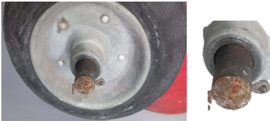
**Tipo de corrosión:** Corrosión uniforme.**Apariencia:** En la parte externa del eje se empieza a notar un color marrón, además de denotarse la pérdida de su pintura anticorrosiva como se muestra en la foto; su pintura anticorrosiva era de un color blanco que se fue perdiendo a lo largo de los años.**Tiempo de servicio:**
