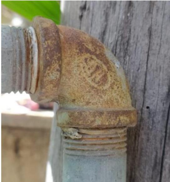
**Tipo de Corrosión:** Corrosión general.**Apariencia:** Superficie cubierta por productos de corrosión de color de color rojizo, que cubren la gran mayoría del codo, es notoria las porosidades del elemento.**Tiempo de servicio:**
