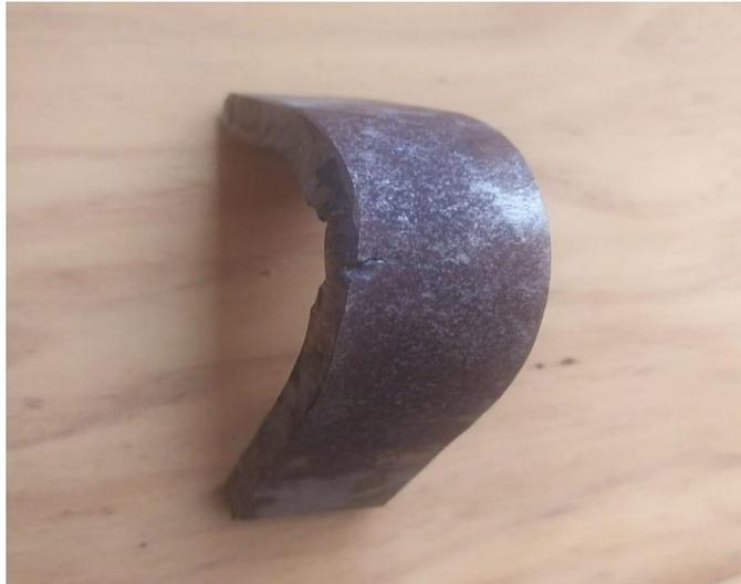
**Tipo de Corrosión:** Corrosión por soldadura.**Apariencia:** Presencia de productos de corrosión en la zona ZAC del cordón de soldadura, agrietamiento mínimo longitudinal en el material de aporte.**Tiempo de servicio:**
