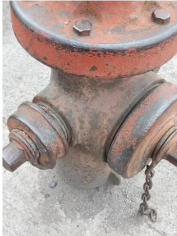
**Tipo de corrosión:** Corrosión atmosférica.**Apariencia:** Producto de corrosión presente en el perno y la tapa del hidratante tomando un color rojizo oscuro.**Tiempo de servicio:**
