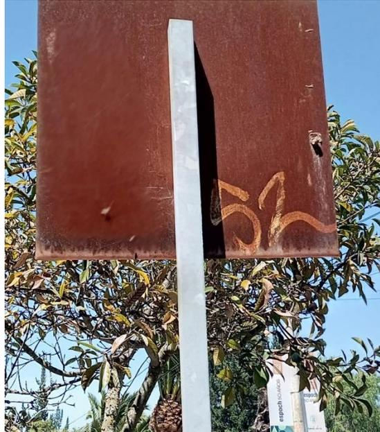
**Tipo de Corrosión:** Corrosión galvánica.**Apariencia:** Cambio de color de la plancha galvanizada de la señalética, productos de corrosión insertados en toda su área, fácil detección del ánodo y cátodo de la celda.**Tiempo de servicio:**
