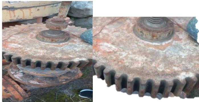
**Tipo de corrosión:** Corrosión uniforme.**Apariencia:** El material presenta en toda su superficie un cambio en su color además de notar el desprendimiento de material de una manera uniforme a lo largo del mismo.**Tiempo de servicio:**
