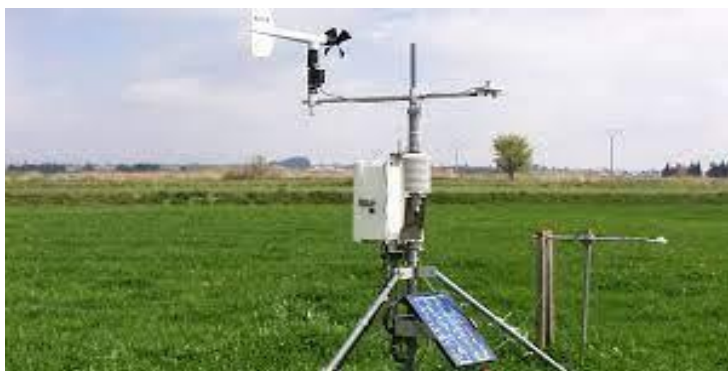
Estación meteorológica automática.
