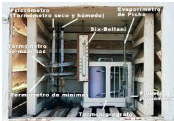
Estación meteorológica manual.
