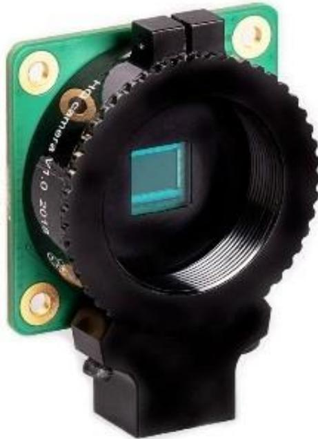
El sensor IMX477 posee una alta sensibilidad, alta tasa de captura de imágenes debido a su tecnología que usa convertidores A/D en columnas paralelas además de tener un bajo consumo de energía debido a que reduce el uso de circuitos analógicos, por lo tanto conlleva una reducción del ruido tal como muestra la Figura 16.
