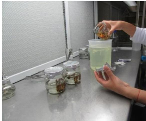
Finalmente, se realiza una inmersión en solución antioxidante de ácido ascórbico 300 mg/L + ácido cítrico 100 mg/L estéril, durante diez (10) minutos (Figura 15).
