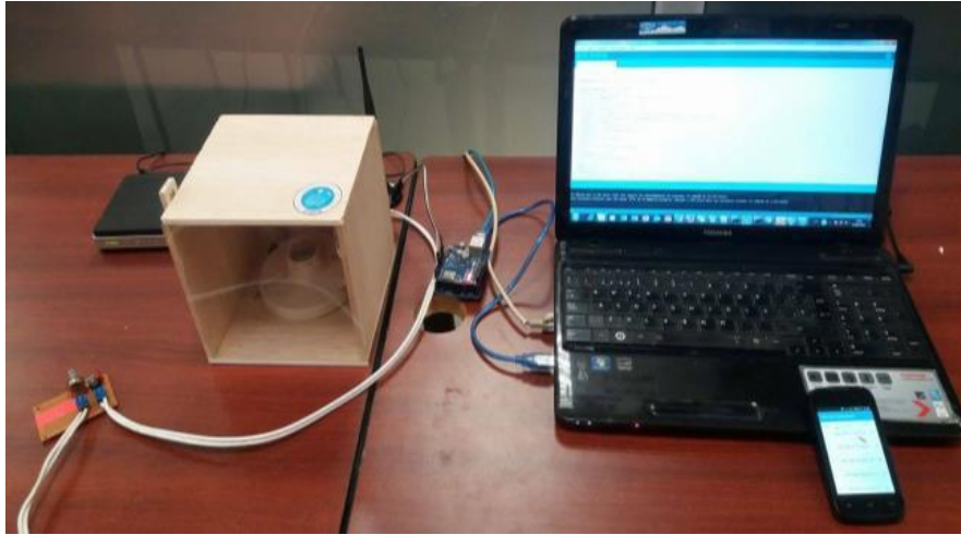
Figura 8. Estructura Física de la Red LAN para monitoreo remoto de temperatura
