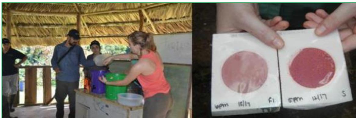
Figura 2. Demostración del funcionamiento de los filtros de agua (izquierda). Demostración de prueba bacteriológica antes (puntos rojos son comunidades de patógenos) y después del filtro.
