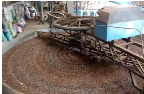
En la figura 1 se puede observar un maquina secadora de cacao tipo industrial que cuenta con removedor de granos lo que hace que el cacao pueda secarse en menor tiempo y de manera homogénea.
