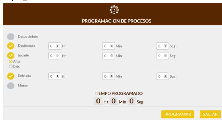
Aquí el usuario programa de acuerdo a las necesidades de secado, y una vez iniciado el proceso, la interfaz muestra un módulo de control y monitoreo, a través de una aplicación Web que provee el servicio que se muestra en la figura 9.
